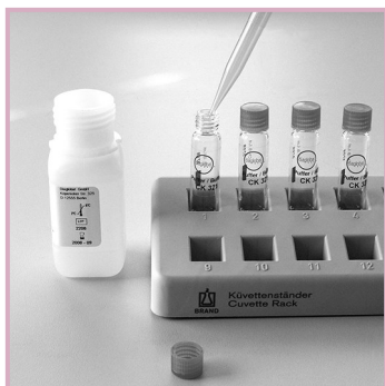
1. Jeweils 500 µL Enzym-Substrat-Lösung in jede Küvette pipettieren
